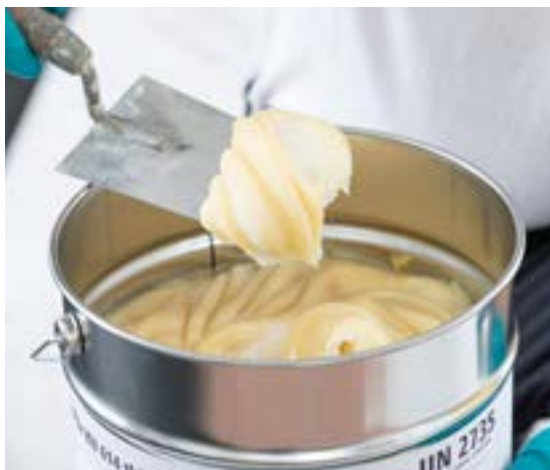
Die Komponente B ist ein vorgefülltes Epoxidharz, mit dem die Oberflächenstruktur erzielt wird. Fotos links + Titel: Martin Baitinger
